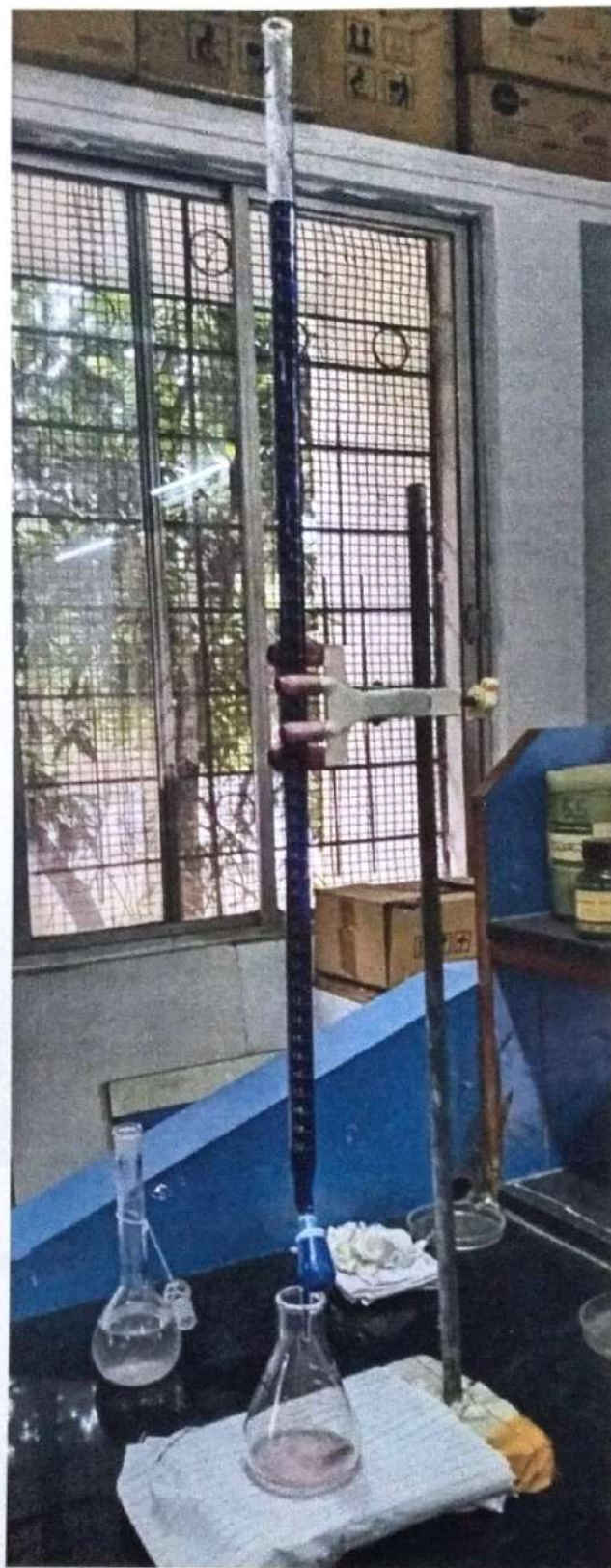
Fig. 5). Titration of dragon fruit juice using 2,6 dichlorophenol indophenol method.
