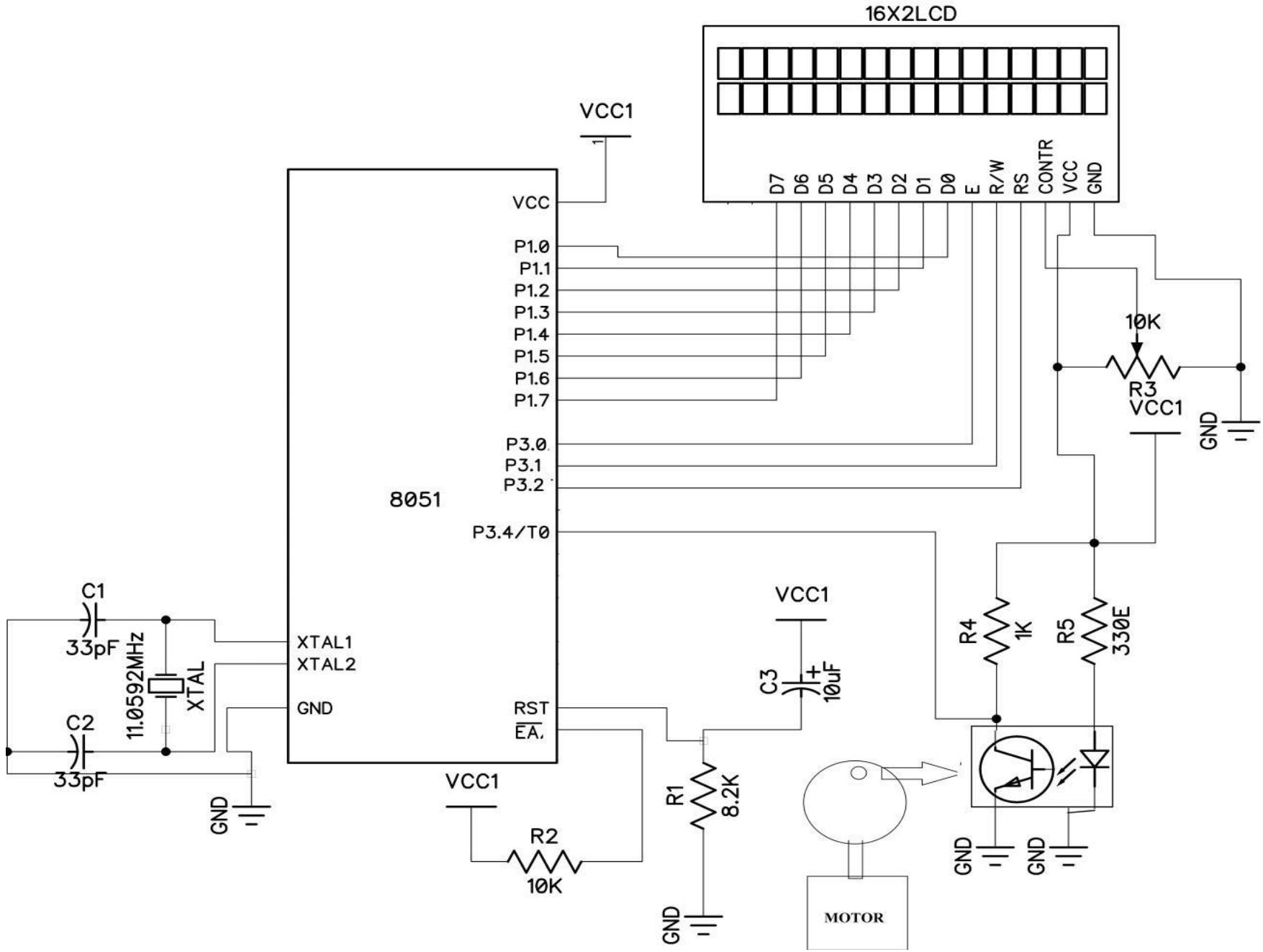
;MOTOR SPEED MEASUREMENT SYSTEM USING 8051
