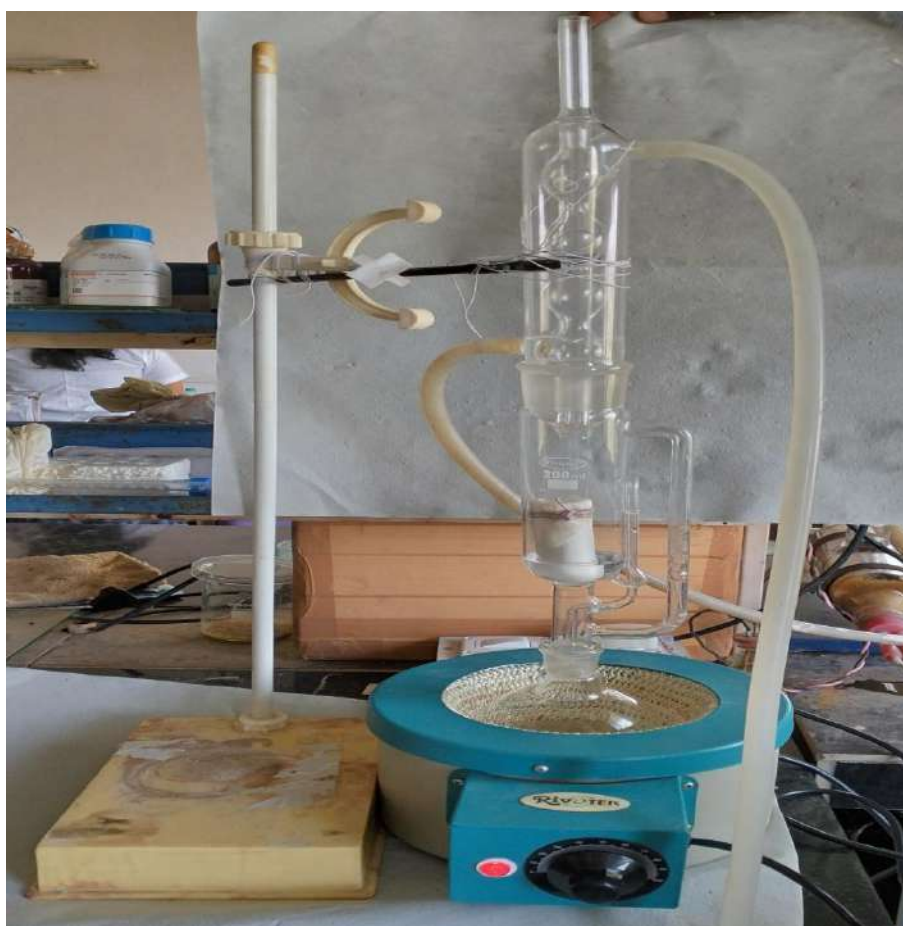
FIG : Soxhlet apparatus.
